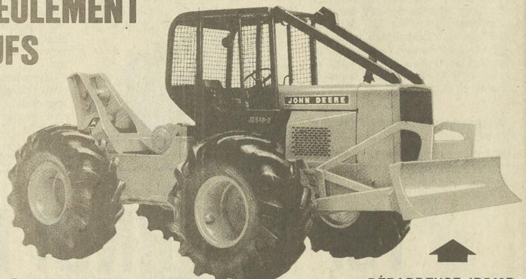
DÉBARDEUSE JD540B Puissance nette SAE de 90 HP, direction par châssis articulé, pont avant oscillant, boîte de vitesses servo, différentiel autobloquant sur les deux ponts et nombreuses autres caractéristiques avantageuses.
