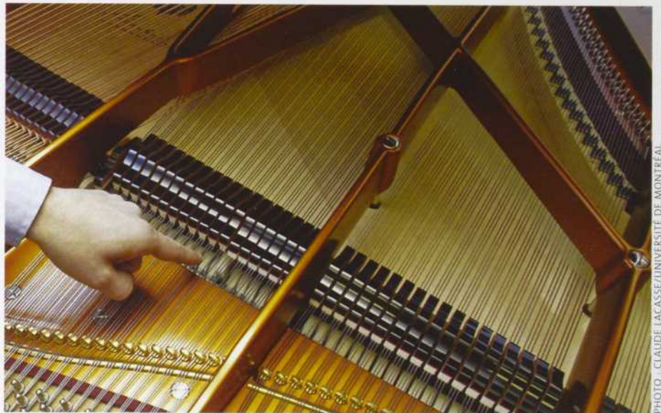
Le piano à queue dont disposent les chercheurs du laboratoire BRAMS est un équipement unique doté d'un système informatique à la fine pointe. Par exemple, la mémoire réactive des marteaux permet d'enregistrer une interprétation, au moyen de capteurs extrêmement précis, de la numériser et de la reproduire telle qu'elle a été jouée par le pianiste.
