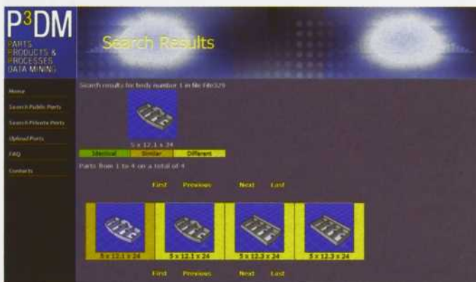
PartFinder , premier module de la suite P3DM , a repéré, dans la base de données, quatre modèles similaires au modèle de référence affiché en haut de l'image.
