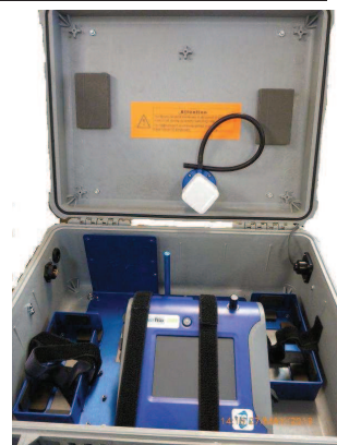
Figure 6 : Analyseur de particules en continu dans sa valise environnementale
