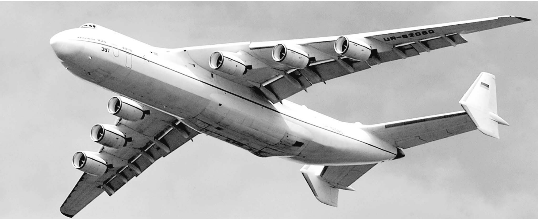
Photo REUTERS Équipé de six réacteurs, l'Antonov AN-225 a une envergure de 88,4 mètres et un compartiment cargo de 43 mètres de long. Renforcé, le Mriya peut maintenant transporter jusqu'à 250 tonnes de fret sur une distance de 4500 km, ainsi que des navettes spatiales.
