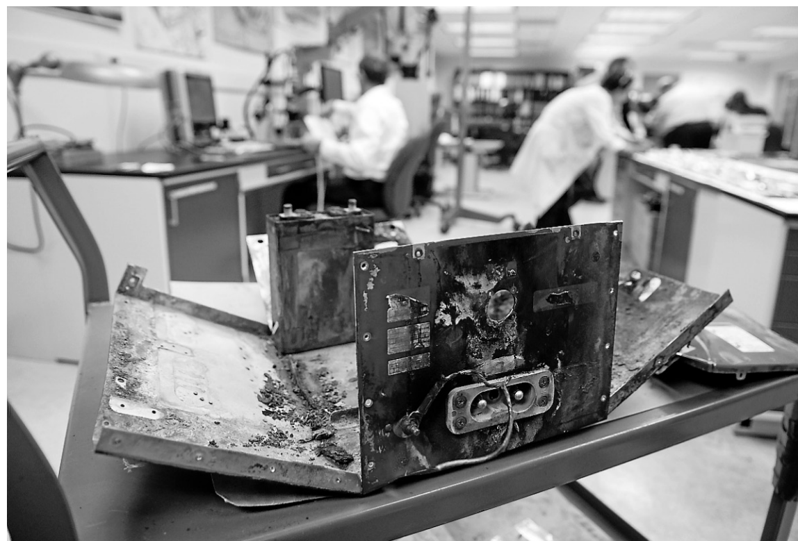
La batterie au lithium-ion endommagée d'un Boeing 787 est étudiée au laboratoire de l'Agence nationale de sécurité des transports des États-Unis. Une firme québécoise, Groupe Bolloré, fabrique des batteries au phosphate de fer lithié réputées plus sécuritaires.
