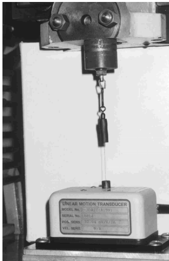
Figure 4 – Position du capteur de déplacement
