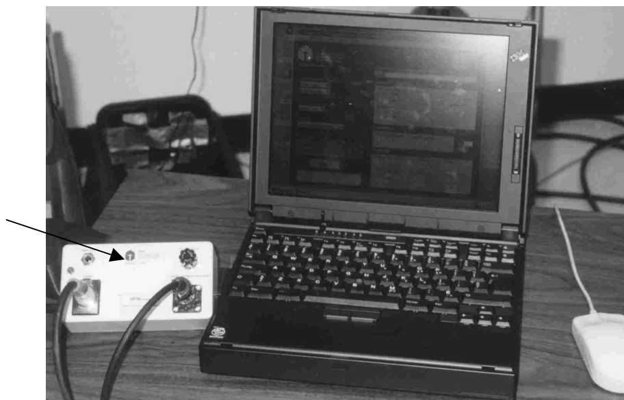
Figure 6 – Branchement du module MPM à l'ordinateur
