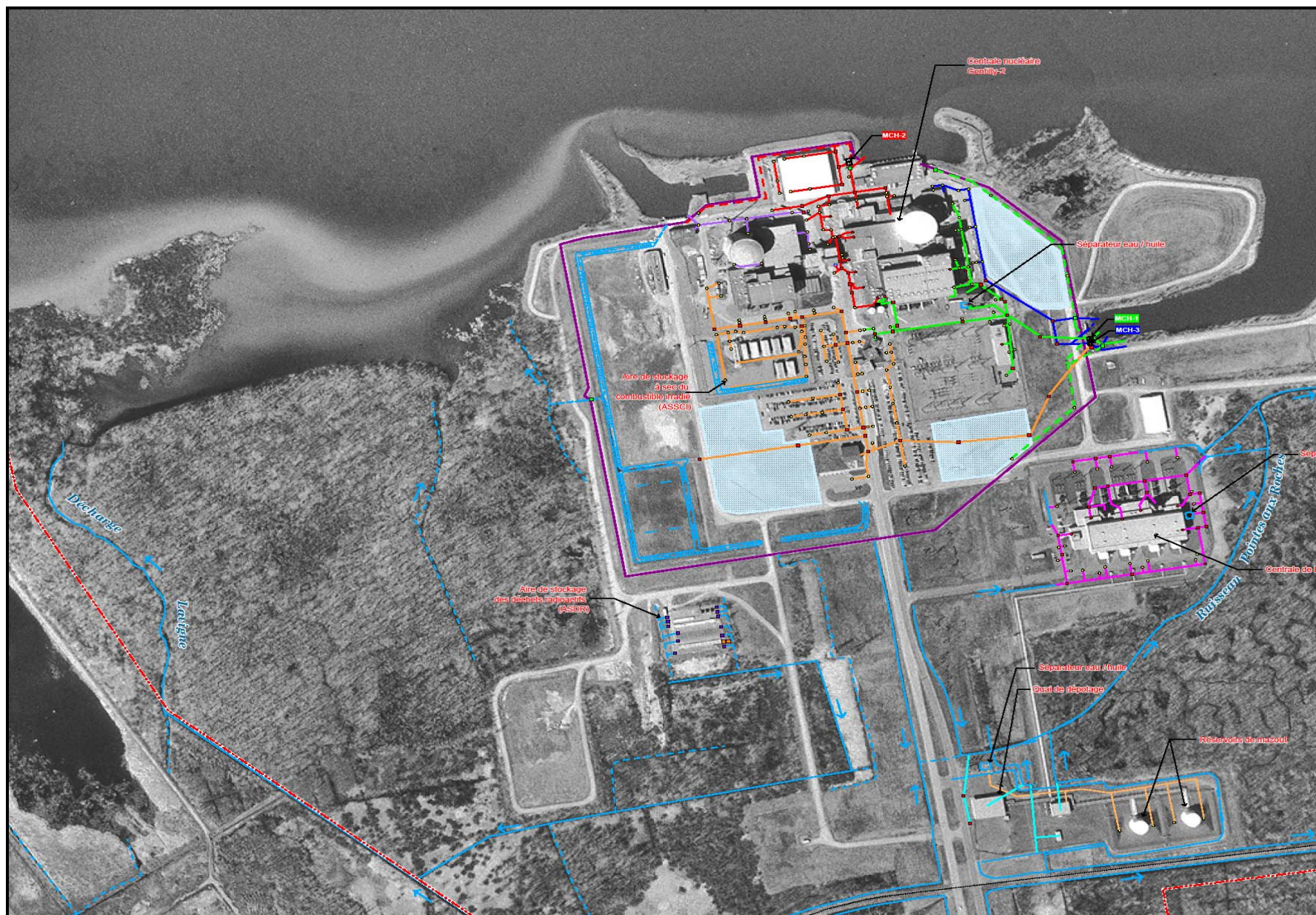
CARTE 8 : Schéma du drainage pluvial et de surface du site de la centrale de Gentilly-2.
