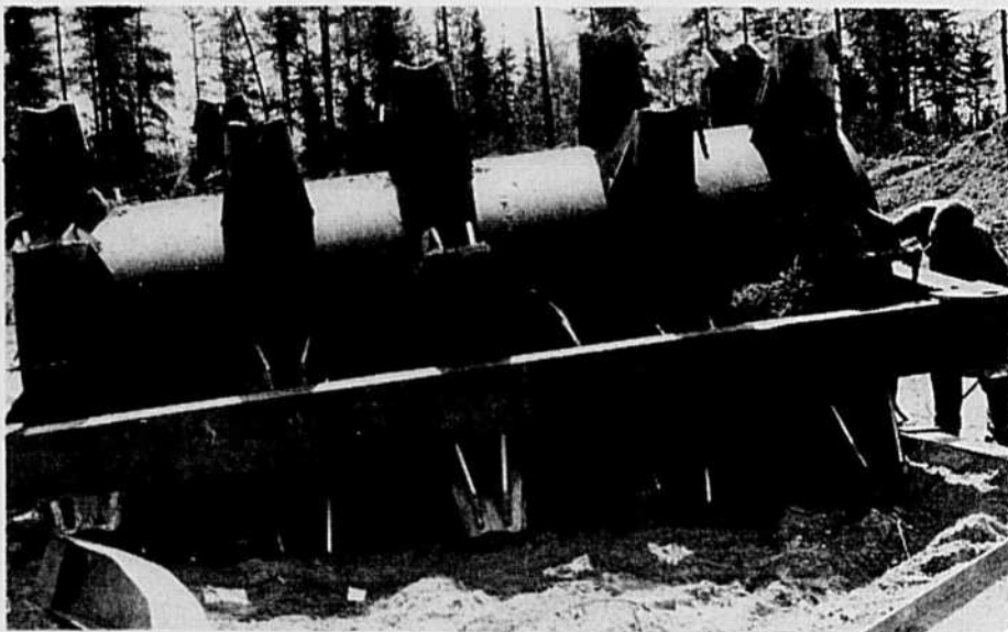
Une fois rendue sur les lieux du travail, la déchiqueteuse est remplie d'eau et elle atteint alors un poids de 57,000 livres.
