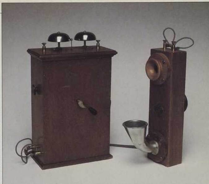
En 1878, l'horloger québécois Cyrille Duquet perfectionne le téléphone inventé deux ans plus tôt par Alexander Graham Bell. Avant-gardiste, il conçoit le téléphone magnéto à combiné émetteur-récepteur, l'ancêtre des appareils téléphoniques actuels.
