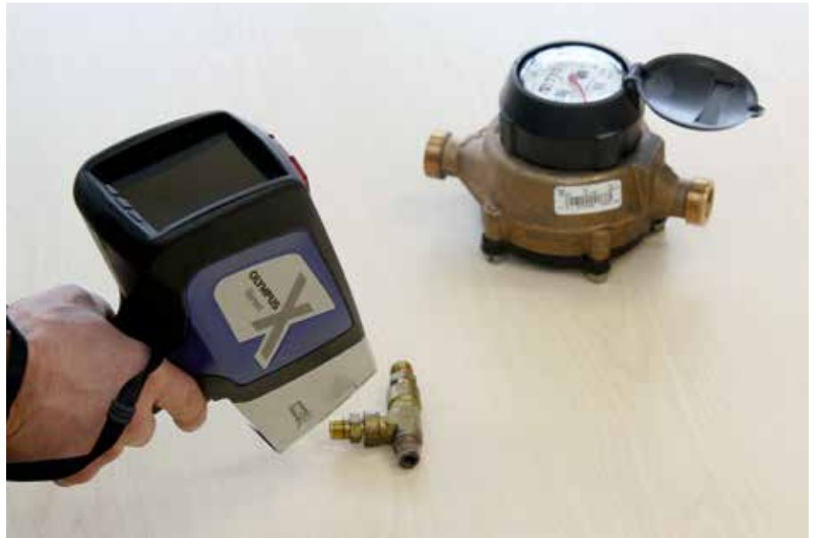
Pistolet à rayons X utilisé par le Centre ACER pour détecter la présence de plomb dans les équipements acéricoles.
