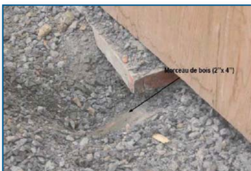
Morceau de bois sous le stabilisateur lors de la visite du 18 juin 2007
