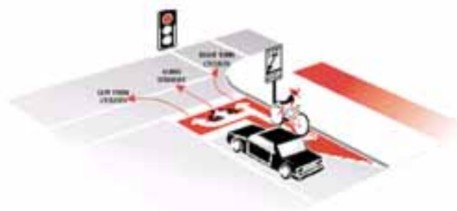
Figure 10.3. Ligne d'arrêt avancée et sas-vélo ou « bike box ».
