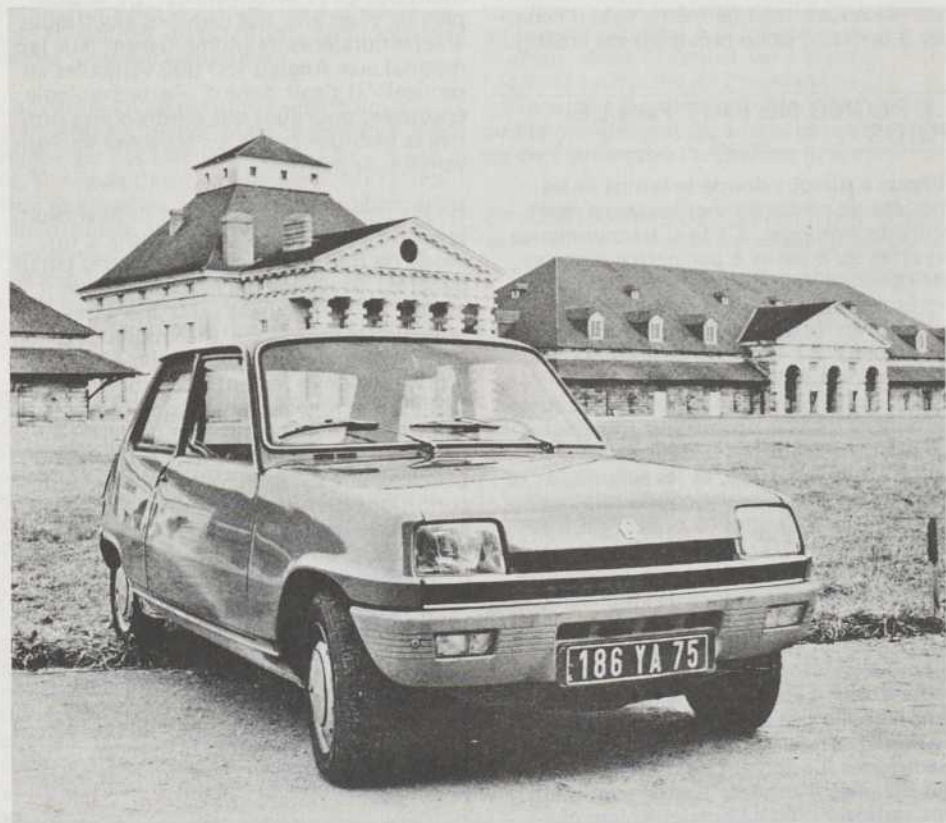
▽ LA RENAULT E.D.F. R5 - Autonomie 100 km. Vitesse 60 km/h.
