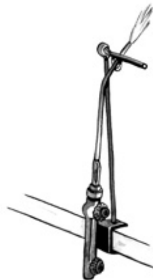
Figure 3.4 Support approprié lors du travail avec un chalumeau
