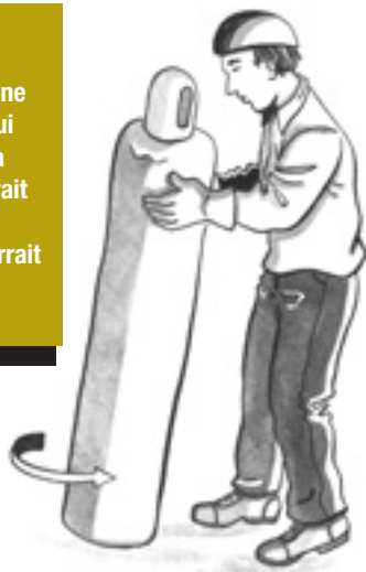
Figure 3.12 Faire rouler une bouteille de gaz en position verticale sur sa base afin de la déplacer ou utiliser un chariot
