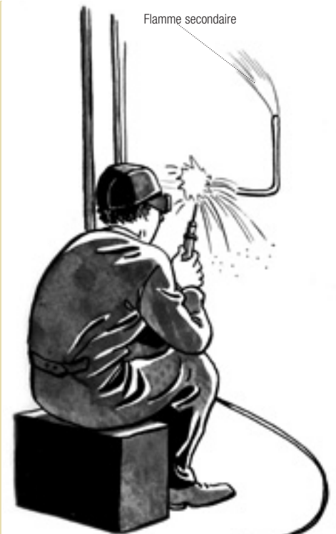
Figure 3.2 Flamme secondaire produite à l'extrémité d'un tuyau ouvert
