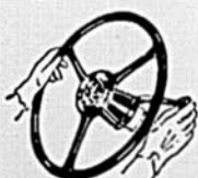
Le levier de changements de vitesses est sur la colonne de direction.
