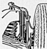
Action indépendante des roues avant avec ressorts en acier Amolo. Amortisseurs de chocs type-avion.
