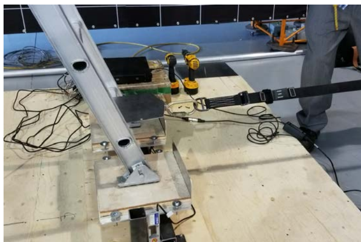
Figure 18. Application d'une force horizontale au bas de l'échelle pour déterminer le coefficient de friction.
