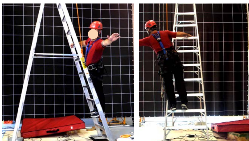
Figure 21. Vérification de la stabilité de l'escabeau - Position 2 : côté (P2).
