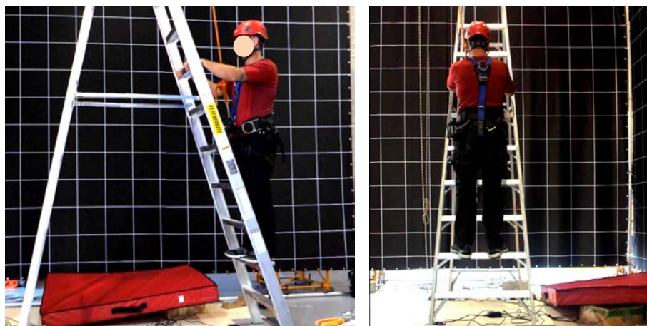
Figure 19. Vérification de la stabilité de l'escabeau - Position de départ.
