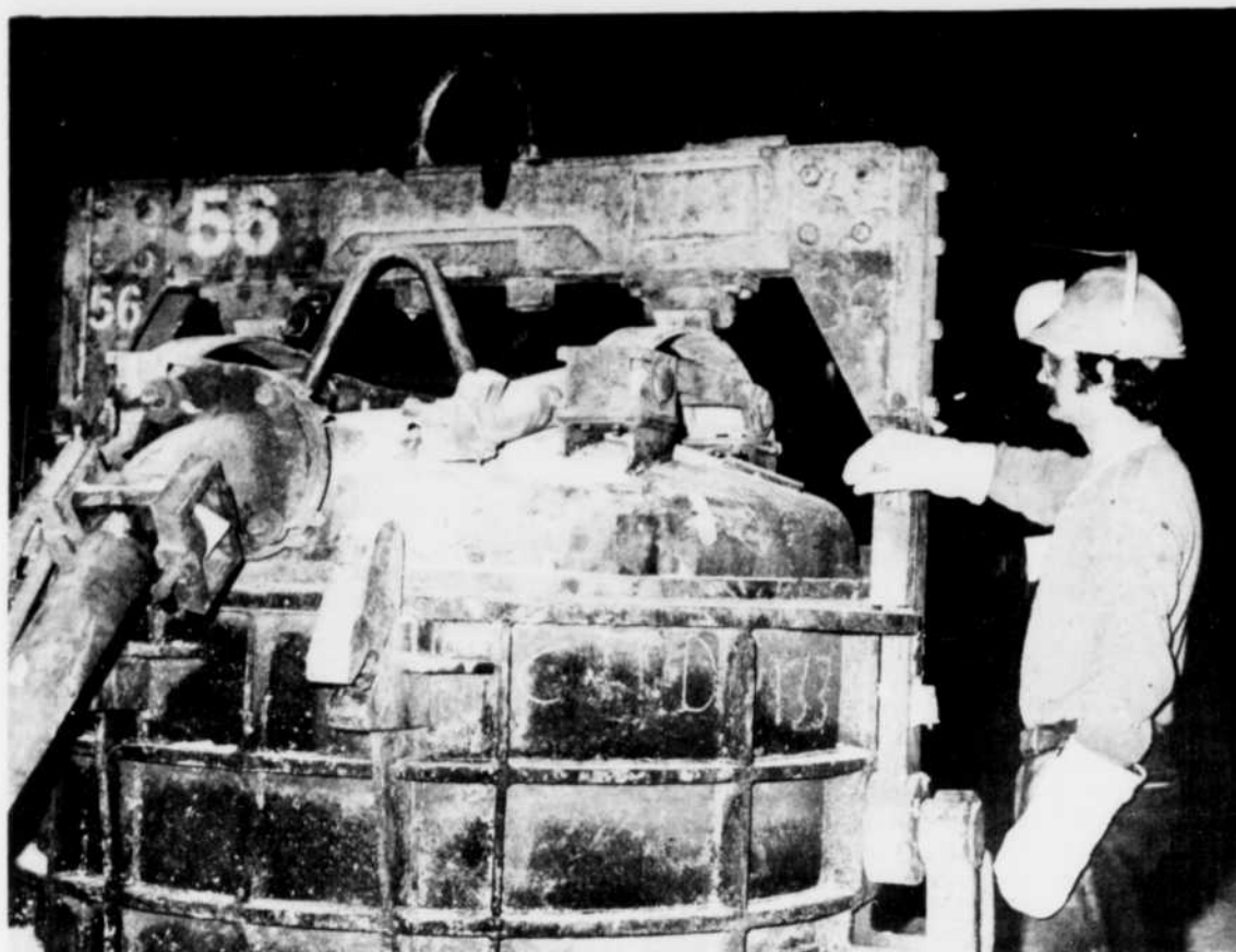
Robert Paquet est l'un de ces employés qui sont bien contents de voir leurs creusets désormais munis de manomètres, de lames de ressort et de silencieux. Ces améliorations sont, à la base, le fruit du travail du service de plans, devis et estimations, du service d'ingénierie de l'Usine Arvida.
