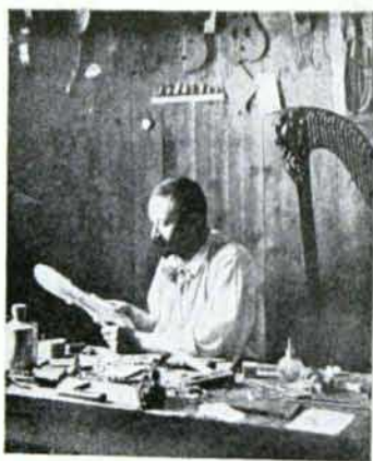
Vérification de l'élasticité de la table de résonance, dite aussi : d'harmonie
