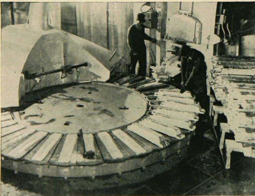
La coulée des lingots. L'usine d'Arvida a une capacité de 2,000,000 de livres d'aluminium brut par jour. Le gros de la production est destiné à l'exportation.
