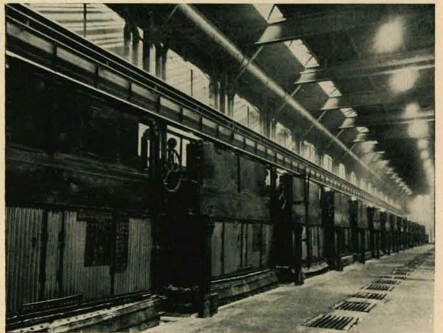
Quelques-unes des cuves électrolytiques où l'aluminium est finalement obtenu de son oxyde, l'alumine. Ici, la consommation d'énergie devient fantastique.
