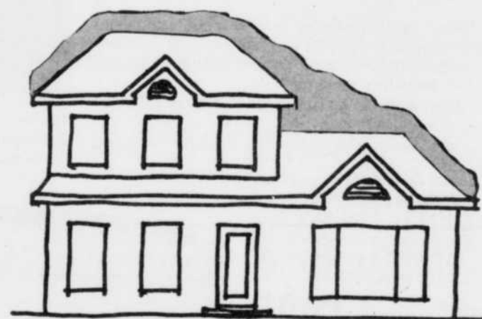
Illustration A : Charge de neige théoriquement statique sur le toit
