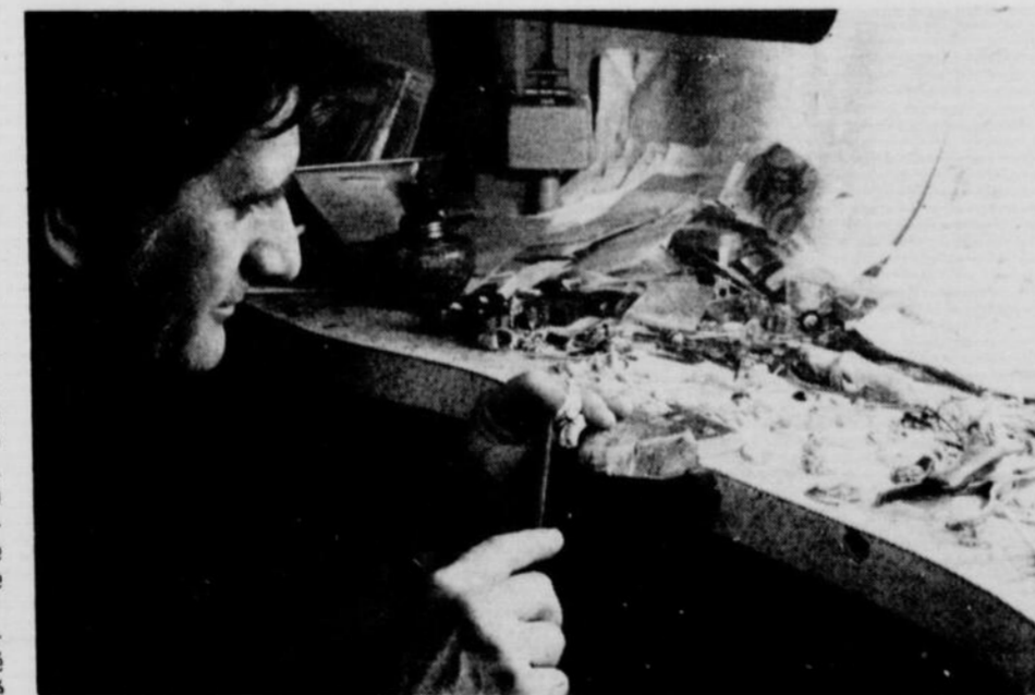
Avant de livrer un produit fini, il reste à couper, limer, polir, sertir les pierres et repolir. Une pièce parfaite demande de l'attention et de la minutie.
