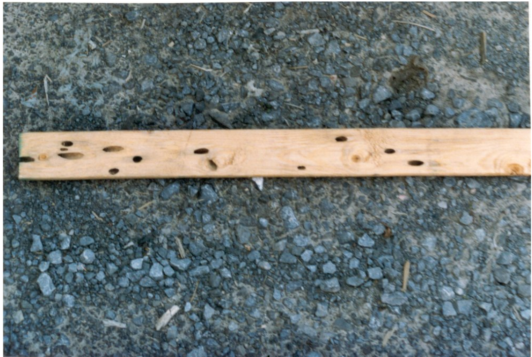
Photo 3.4.3 a) – Altération moyenne causée par les insectes
