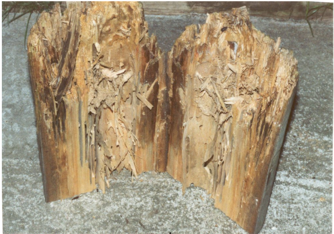
Photo 3.4.3 b) – Altération très importante causée par les insectes
