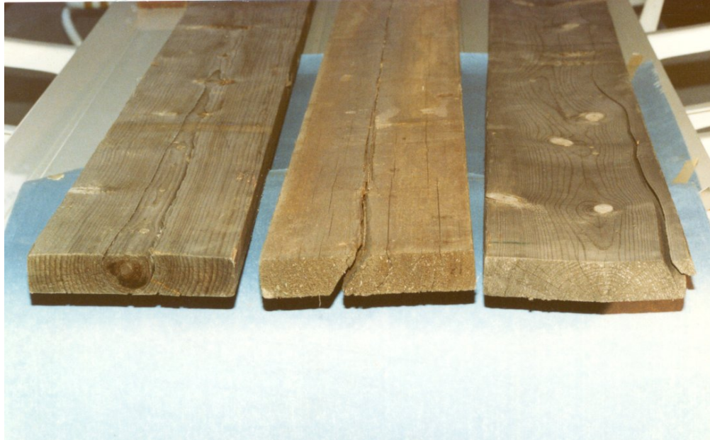
Photo 3.4.1 c) – Les roulures de cœur, en travers et de rive
