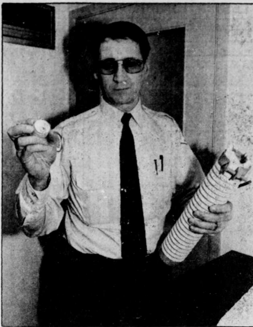
Un policier de Charlesbourg exhibe de la main gauche le parafoudre qui a fait explosion. Il tient dans l'autre main la pièce de métal projetée lors de la déflagration et qui s'est enfoncée dans le toit de l'automobile de M. Roger Hamel.
