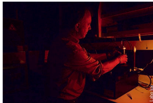
Le travail en laboratoire de luminescence se fait en lumière tamisée et filtrée pour longueur d'onde se rapprochant de l'orange.
