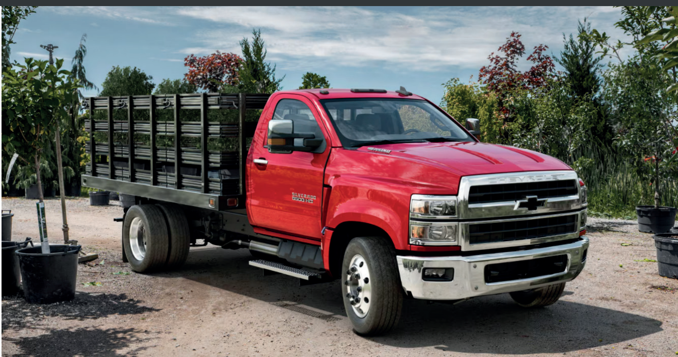
La conception plane des longerons offre une flexibilité maximale pour les carrosseries spécialisées, des plateaux à ridelles aux bennes à basculement.
