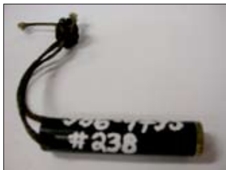
Photo 1. Thermographe à enregistrement continu de marque Vemco.
