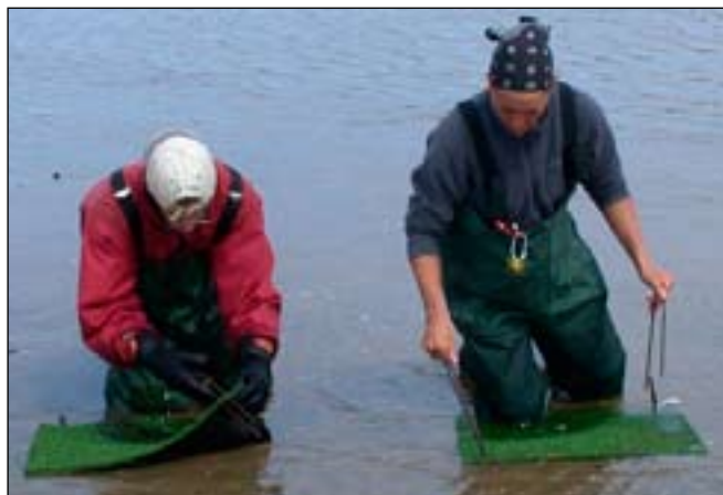
Photo 1. En juin, installation des tapis Astro-turf™ dans la zone intertidale pour le suivi de captage benthique.
