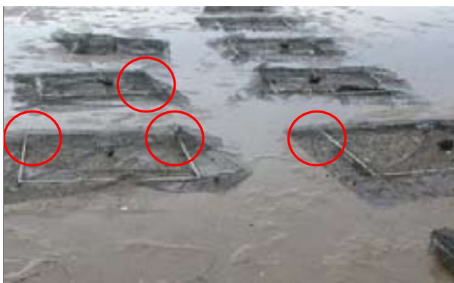
Photos 7 et 8. Parcelles en aluminium avec des pattes. Les cercles rouges indiquent des parties qui ne sont pas en contact avec le substrat.
