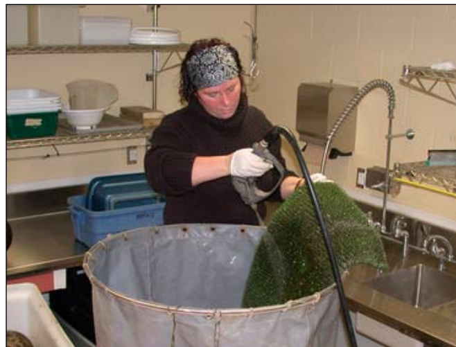
Photo 4. Nettoyage automnal des tapis benthiques effectué avec une laveuse à pression.
