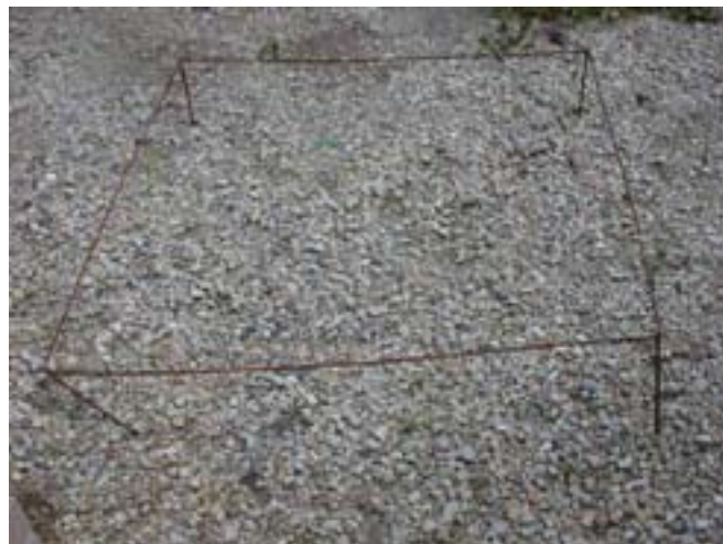
Photo 6. Parcelle métallique de 4 m 2 avec des pattes de 30 cm aux quatre coins.
