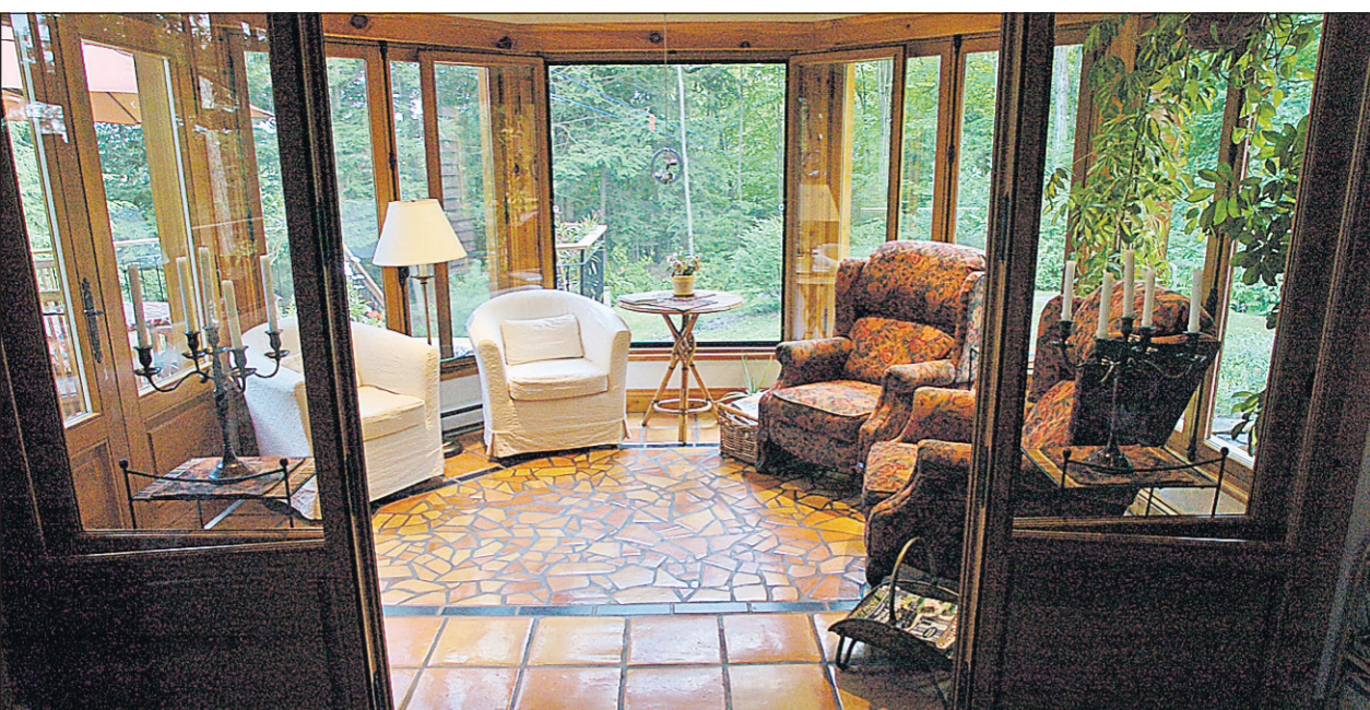
Les carreaux de terre cuite ont été privilégiés dans le solarium, car ils conservent la chaleur du soleil l'hiver.
