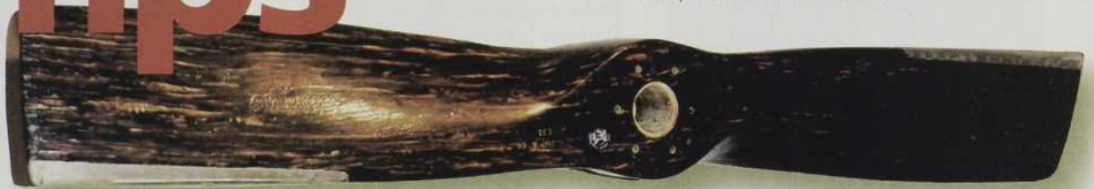
Hélice en bois utilisée sur de petits avions et des moteurs à essai, fabriquée au début des années 70.
