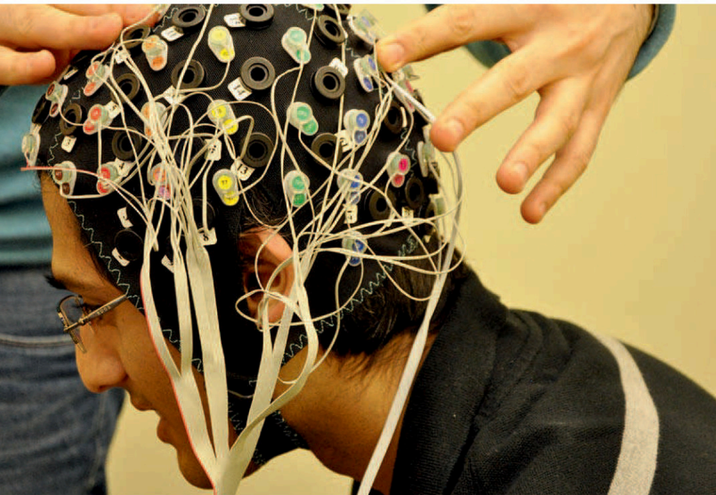
Ce casque médical du laboratoire MuSAE permet de combiner les techniques d'électroencéphalographie et de spectroscopie infrarouge.
