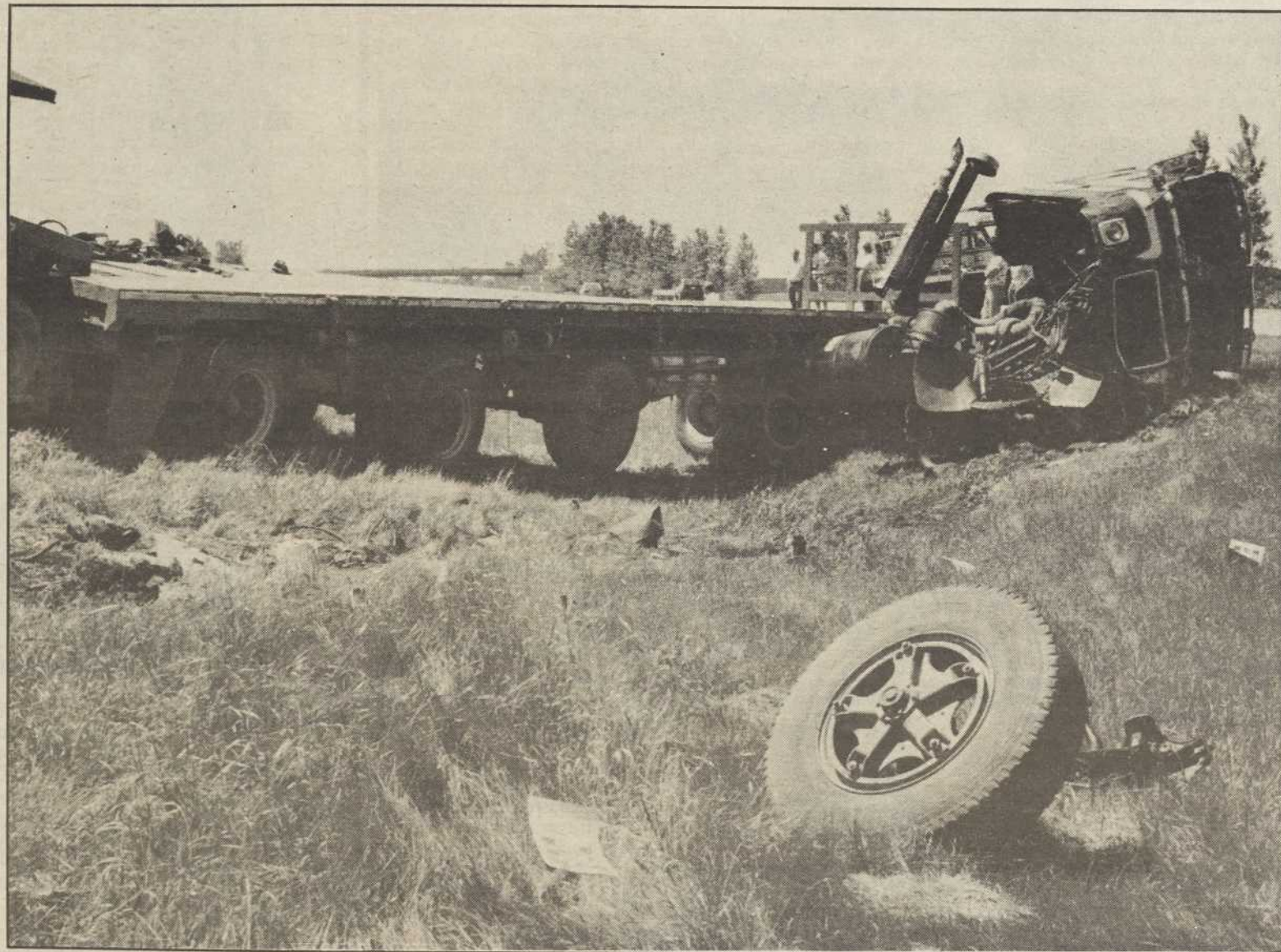
Le camion-remorque est devenu incontrôlable lorsque l'essieu auxiliaire (troisième à partir de la gauche) qui aurait dû être levé, est entré en contact avec la chaussée à la suite d'un déverrouillage accidentel causé par une défectuosité électrique.
