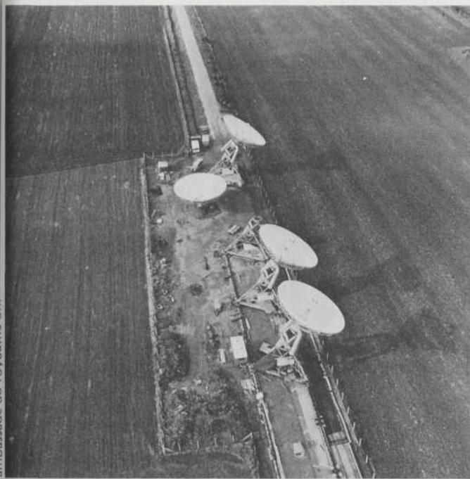
À L'ÉCOUTE DES PULSARS — Le nouveau radiotélescope de l'Observatoire Mullard à Cambridge (Royaume-Uni). De conception révolutionnaire, il équivaut à une seule antenne qui aurait 5 kilomètres de diamètre. C'est grâce à cet appareil que le Dr Jocelyn Bell Burnell a découvert les pulsars.
