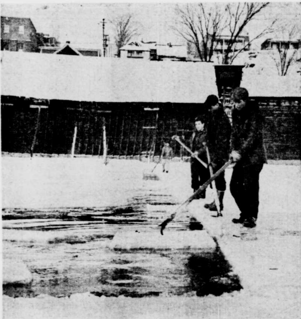
Dénouement — Tout est consommé! Les énormes blocs carrés se détachent les uns des autres. La coupe proprement dite est dès lors terminée. Il s'agit maintenant de
