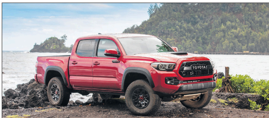
Le Toyota Tacoma TRD Pro est une camionnette de taille intermédiaire. Le moteur est un V6 de 3,5 l (278 ch, 265 lb-pi).
