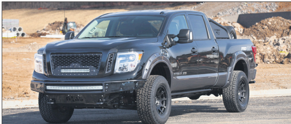
Il est possible de personnaliser le Titan XD Pro-4X avec des pièces Motorsports de Nissan. Le moteur est un V8 turbodiesel Cummins de 5,0 l (310 ch, 555 lb-pi).
