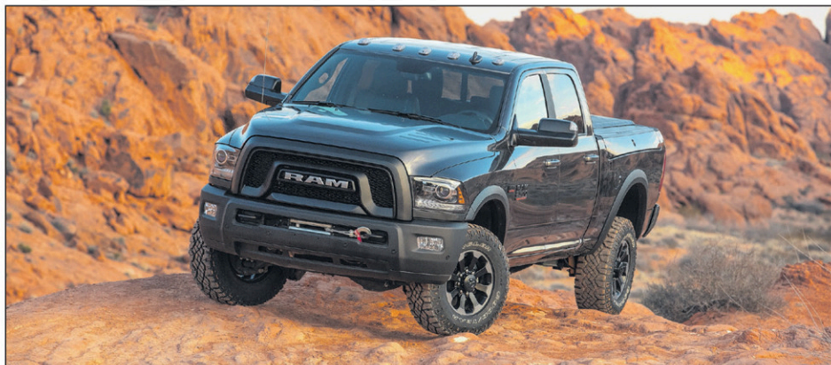
Le Ram 2500 Power Wagon ouvre son capot à un V8 de 6,4 l (410 ch, 429 lb-pi). La capacité de remorquage atteint 4672 kg et la garde au sol est de 36,3 cm.
