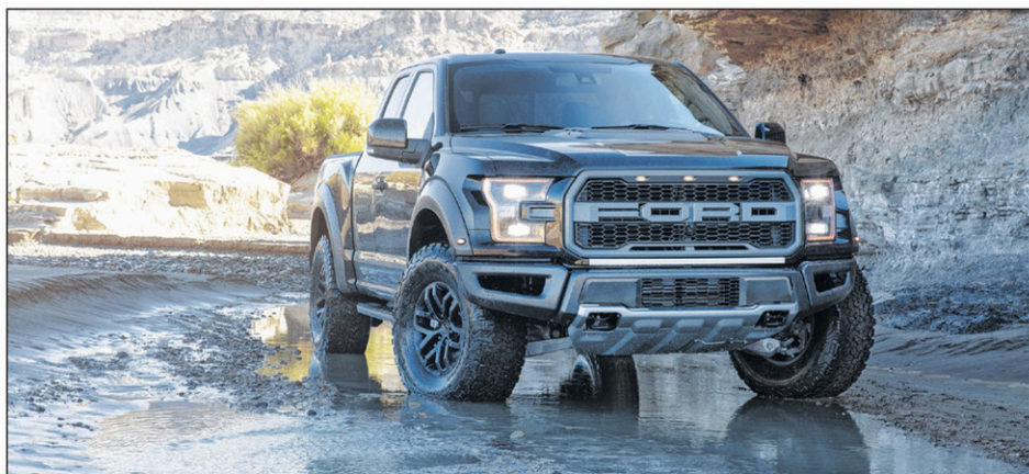
Le Ford F-150 Raptor a délaissé le V8 de 6,2 l (411 ch, 434 lb-pi) pour un V6 biturbo de 3,5 l (450 ch, 510 lb-pi). La taille des pneus est 315/70R17 et la garde au sol atteint 29,1 cm.
