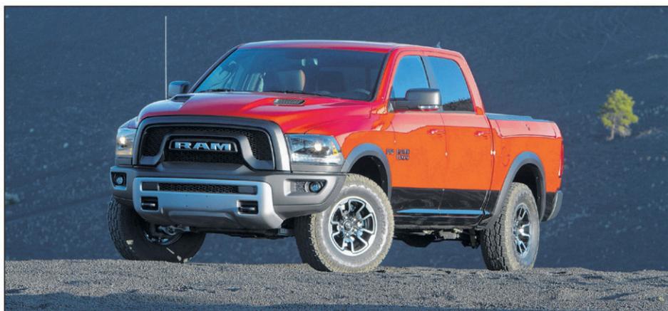
Le Ram 1500 Rebel est propulsé par un V6 de 3,6 l (305 ch, 269 lb-pi) ou un V8 de 5,7 l (395 ch, 410 lb-pi). La grandeur des pneus est 285/70R17 et la garde au sol mesure 27,9 cm.
