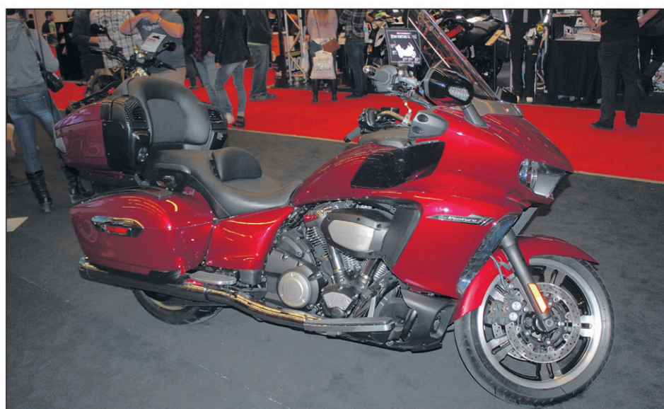
La Yamaha Star Venture TC est une touring équipée d'un bicylindre en V de 1854 cm 3 et d'une boîte à 6 rapports. L'instrumentation éternelle un écran de 17,8 cm.
