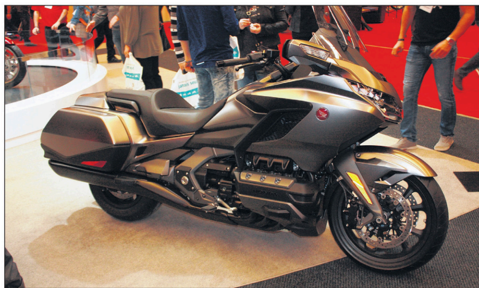
La Honda Gold Wing a été entièrement redessinée. La position de conduite est plus basse et le moteur est un nouveau six cylindres à plat de 1833 cm 3 .
