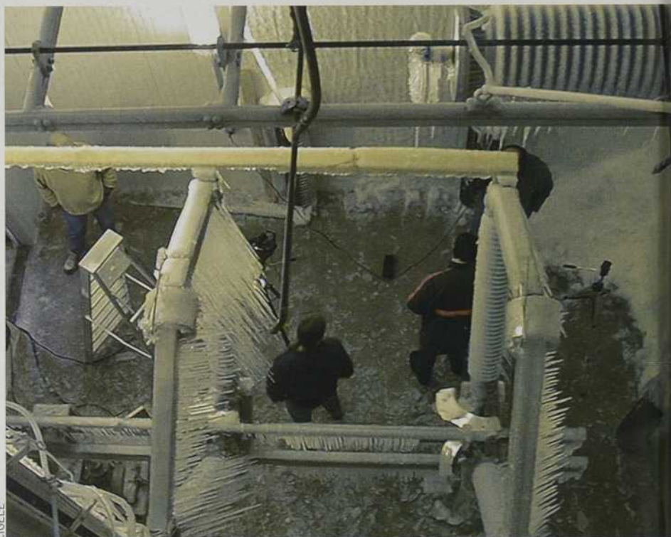
La pluie, le givre, le vent, le froid: on reproduit presque tout dans le laboratoire de la Chaire industrielle sur le givrage atmosphérique des équipements des réseaux électriques.
