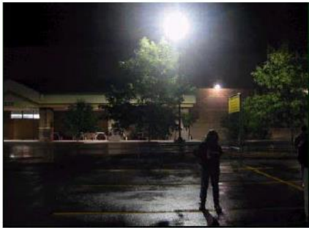
Figure 15. Exemple d'un éclairage extérieur créant de l'éblouissement
