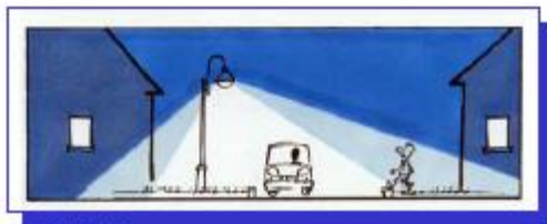
Figure 16. Éclairage limitant la lumière intrusive (gauche) et favorisant la lumière intrusive (droite)
