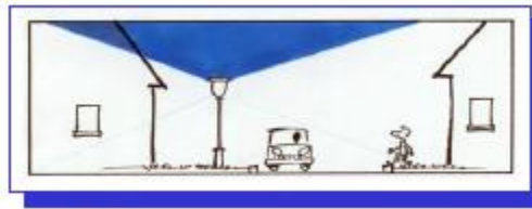
Figure 16. Éclairage limitant la lumière intrusive (gauche) et favorisant la lumière intrusive (droite)
