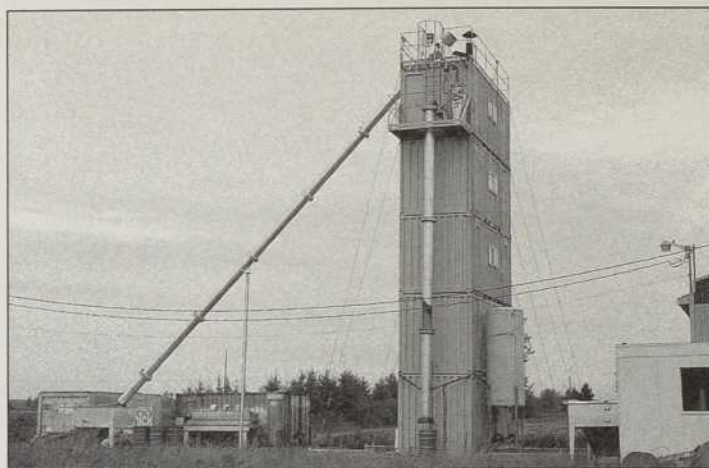
L'usine pilote de pyrolyse sous vide, à Saint-Amable. Chaque année, les Québécois mettent au rebut entre quatre et cinq millions de vieux pneus. Le procédé de la pyrolyse sous vide offre une solution à ce problème environnemental en transformant les déchets de pneus en produits recyclables et utiles.
