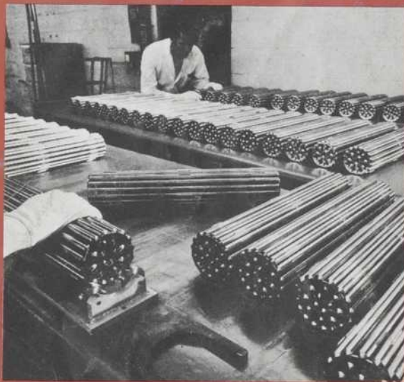
Inspection des grappes de combustible nucléaire.
