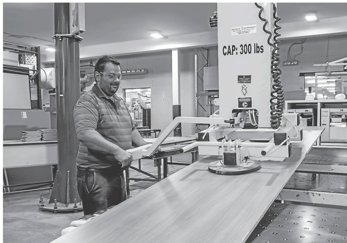
Éric Phaneuf profite du dernier jouet automatisé chez Logiflex, une ventouse qui permet aux employés de lever de grandes charges sans faire d'effort physique. — PHOTO SPECTRE MÉDIA, JESSICA GARNEAU
