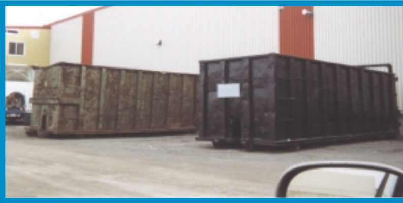
Photo 9. Conteneur à roulage direct pour les résidus industriels - Sorel-Tracy
