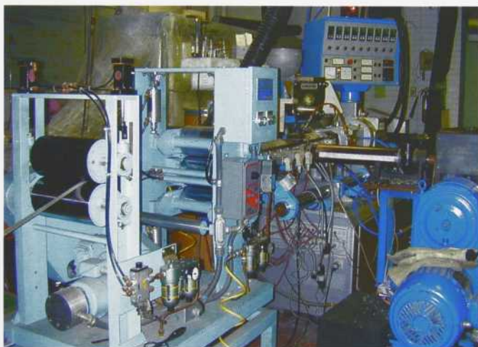
1. Production d'un ruban de polyéthylène/amidon thermoplastique par extrusion.
