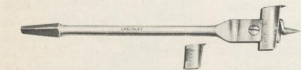
FIG. 26 — Mèche extensible pour vilebrequin. Ajustement difficile par tâtonnement et vis de blocage seulement.
