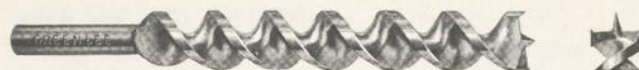
FIG. 8 — Mèche torse avec traçoirs et pointe lisse "dite pointe de diamant". Elle doit être employée sur les machines fixes pour le travail de précision.
