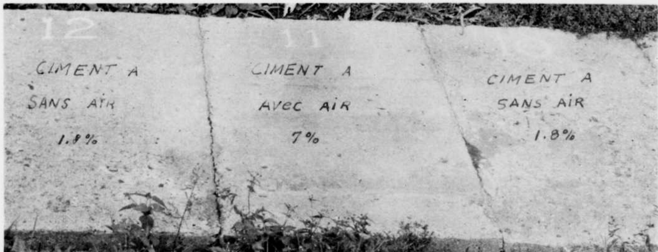
Fig. 7a — Dalles d'un trottoir d'expérimentation. Effet de l'occlusion de l'air
