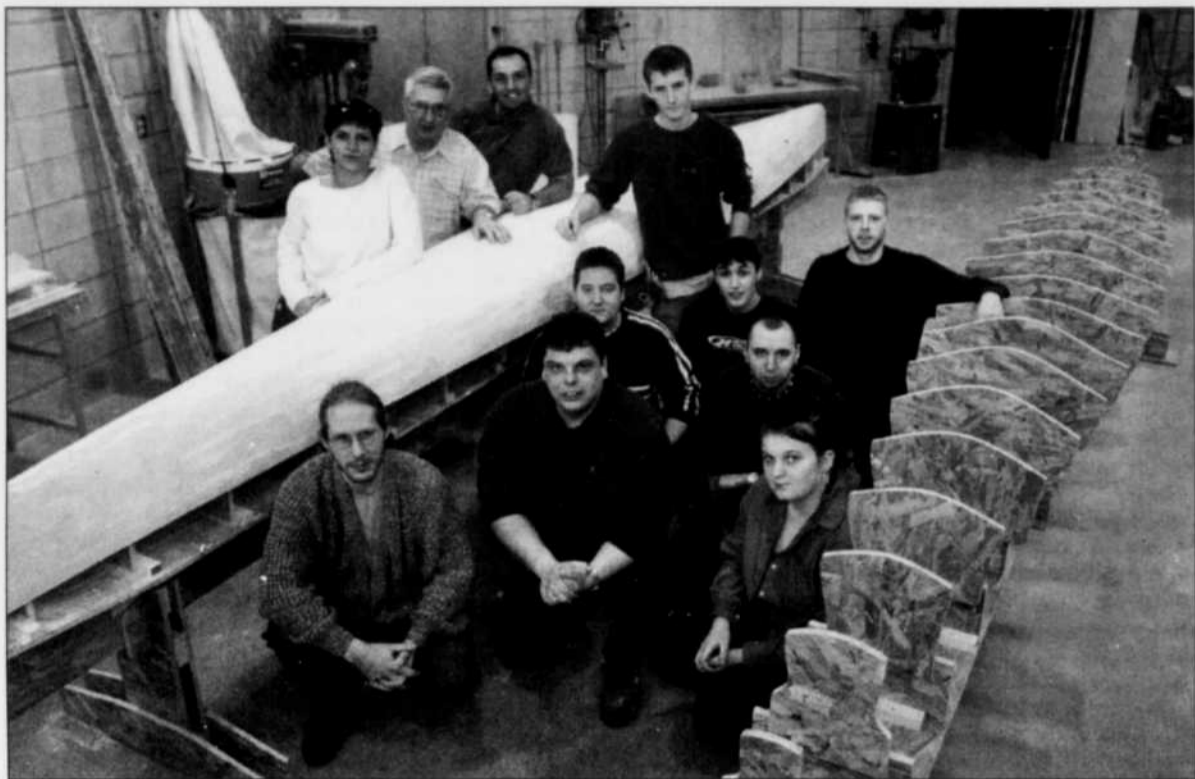
ENTHOUSIASTES - Ces étudiants du centre de formation professionnelle de la Polyvalente de La Baie sont emballés par la construction d'un kayak de mer en fibre de verre. Ils posent devant le prototype en bois qui servira de maître-moule: à l'avant: Frédéric Tessier, Éric Foster, Mélissa Néron; 2e rangée, Keven Bergeron, Karl Dufour, Benoît Bouchard et Martin Janelle; debout, Pascal Tremblay, et de l'autre côté du kayak, Julie Gagnon, Léon Potvin, professeur, et Gérald Morin.
