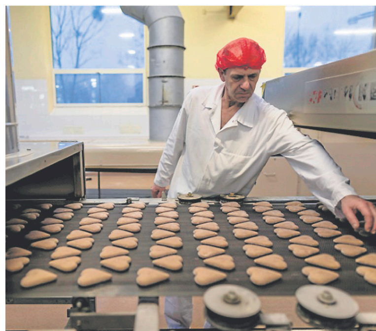
Dans une partie de l'établissement, un tapis roulant fait entrer des pains d'épices en forme de coeur dans un four long de 36 mètres, où ils subissent une cuisson de sept minutes. — PHOTO AFP
