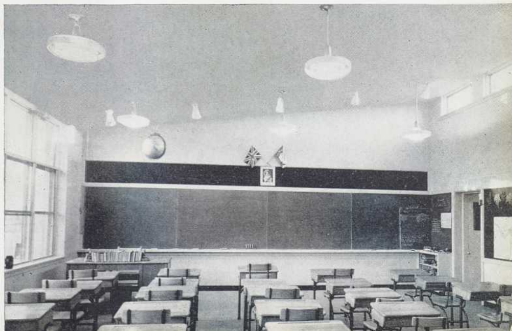
Une salle de classe. Eclairage naturel des deux côtés, par larges fenêtres et claire-voies.
