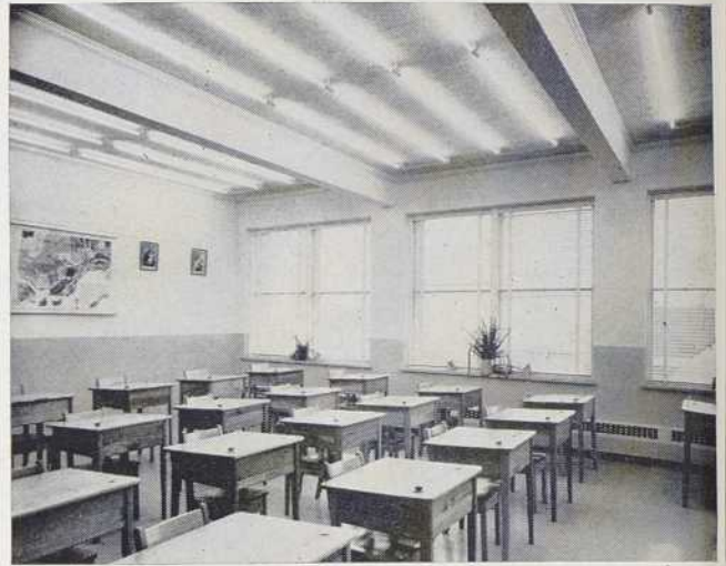
Une classe type. L'éclairage est du type "cold cathode", le chauffage aux plinthes.
