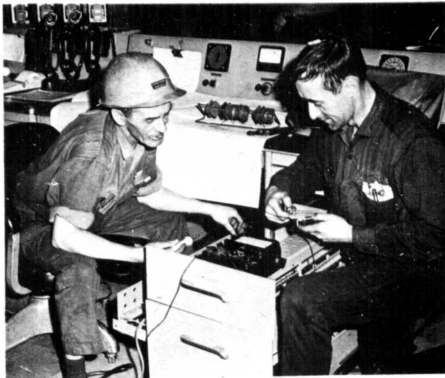
FEL UN APPAREIL DE RAYONS-X — Cet instrument de mesure permet de voir si les circuits et les relais de contrôle sont en bonne condition de marche, ce dont s'occupent deux hommes de l'équipe des électriciens de la section des redresseurs à l'usine Alcan d'Isle-Maligne. A gauche, c'est M. Fernand Girard, son collègue est M. Benoît Gaudreault.
