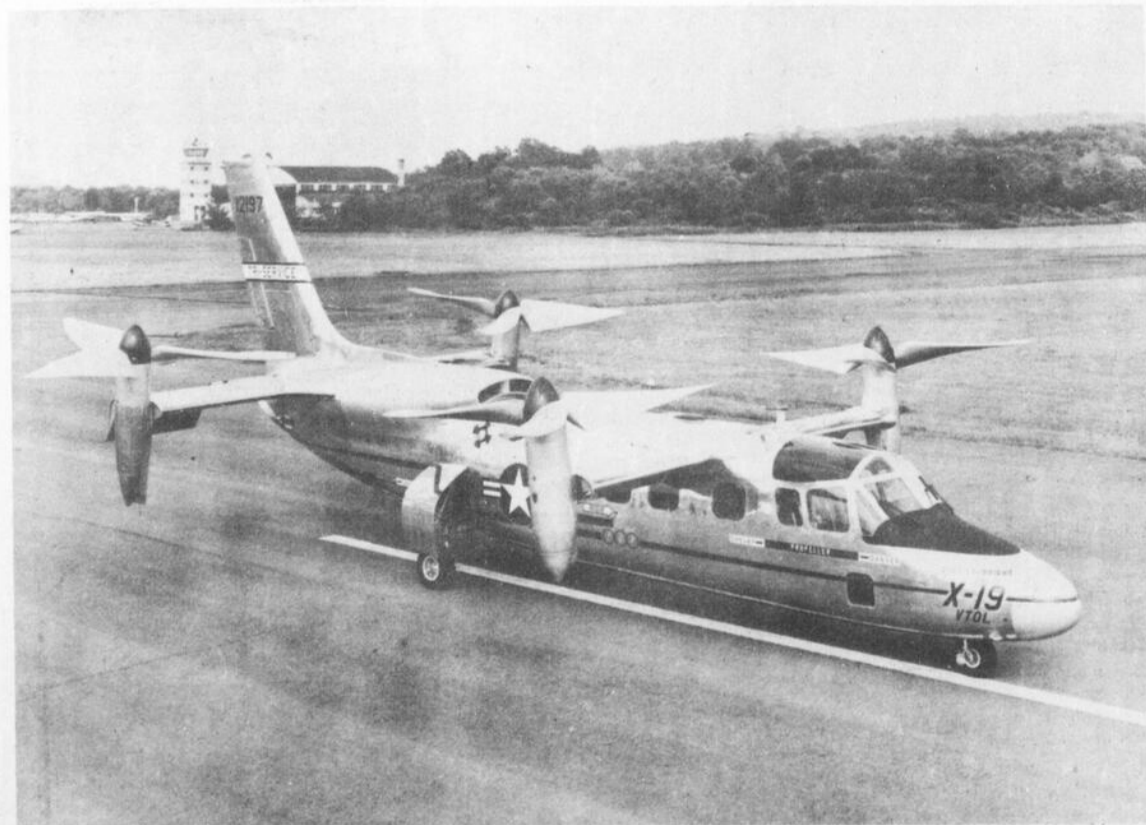
A Caldwell (New-Jersey) a été récemment présenté le nouvel avion américain "X. 19 CURTIS-WRIGHT" qui a la particularité de pouvoir voler aussi bien verticalement qu'horizontalement, ce qui n'empêche pas cet appareil d'atteindre la vitesse de 742 kilomètres à l'heure. La transition entre le vol vertical et le vol horizontal est obtenue par le changement de position (à 90°) des quatre hélices. (Photo AFP)
