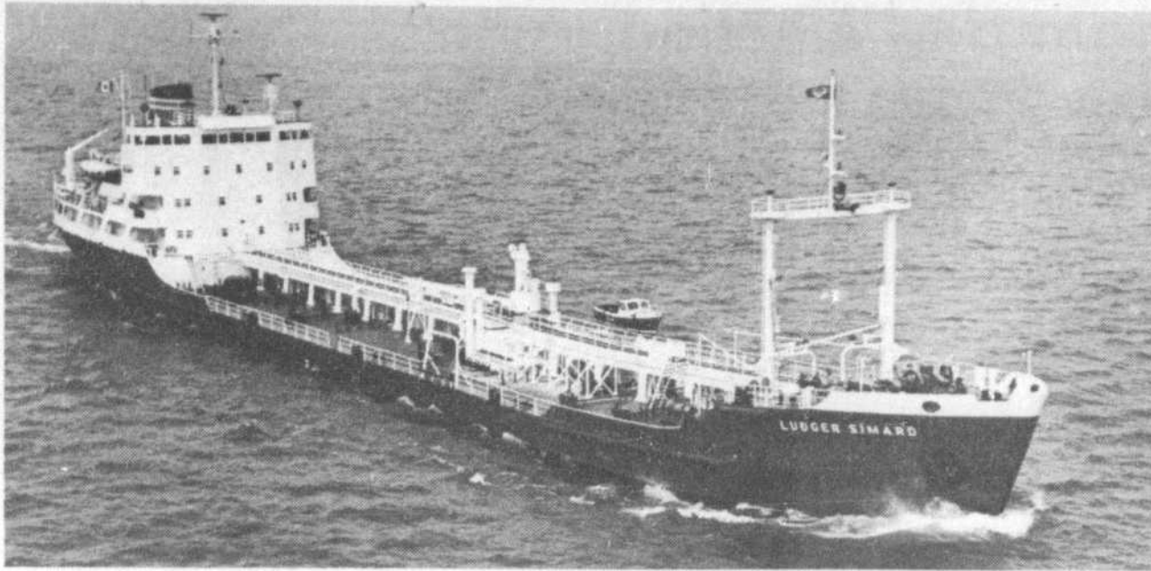
Le "Ludger Simard", pétrolier de 7.000 tonnes capable d'affronter l'Arctique et les Grands lacs, a été livré aujourd'hui à la compagnie Branch Lines par les chantiers Marine Industries de Sorel. Le navire-citerne, qui peut contenir 63.000 barils de produits pétroliers, et baptisé du nom de feu Ludger Simard, ex-président de Marine Industries, sera sous le commandement du capitaine J. Robert Gagnon. Un dispositif électronique permettra de suivre à tout moment le fonctionnement du navire.
