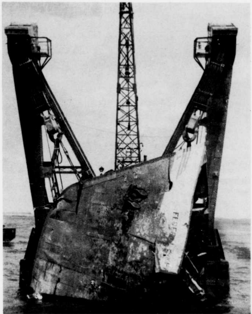
Fig. 4 — La proue du bateau tirée à la surface par les gros palans du ponton-grue, le Scarboro de la Cie Foundation. Un poids dépassant 80 tonnes.
